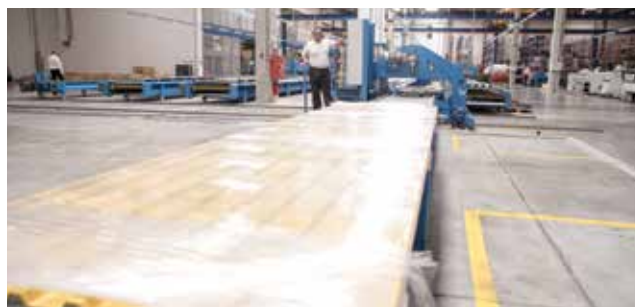
9. kép: Automata csomagoló gyártóegység, amely 5 lemezgyártó sort szolgál ki
