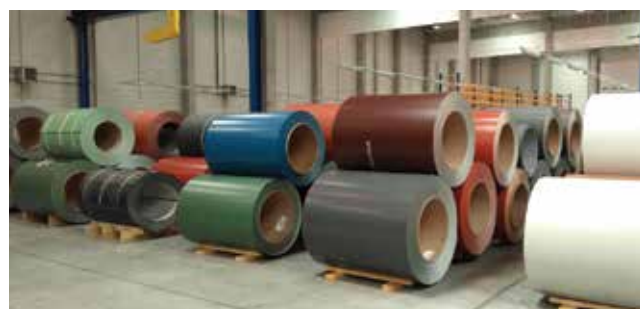
2. kép: Szerves bevonattal ellátott, tűzhorganyzott acéllemez
