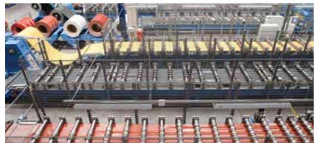
6. kép: Cserepeslemez- és trapézlemez-gyártó hengerek
