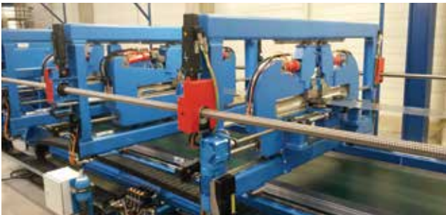
4. kép: Vékonyfalú Z-/C-/U-szelvényt gyártó sor repülő lyukasztó egysége
