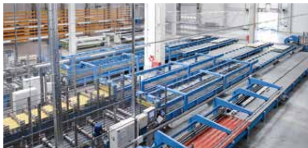
8. kép: Termékfogadó és -továbbító asztal (konvektor) a lemezgyártó sorok végén
