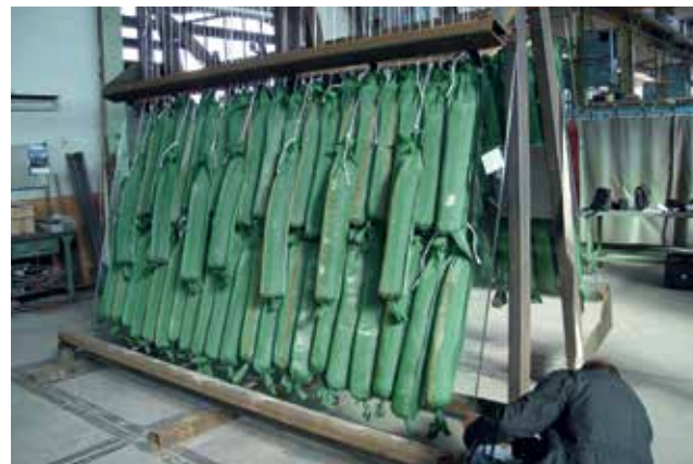
4. kép: Döntött üveglapok tesztelése
