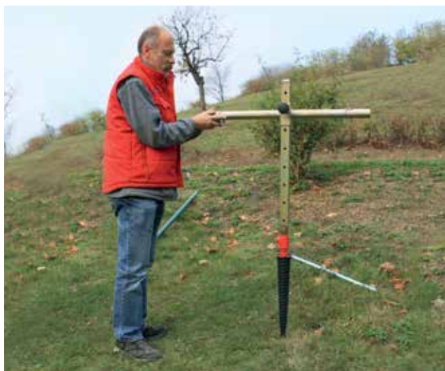
2. kép: A talajcsavar behajtásához alkalmazott eszköz
