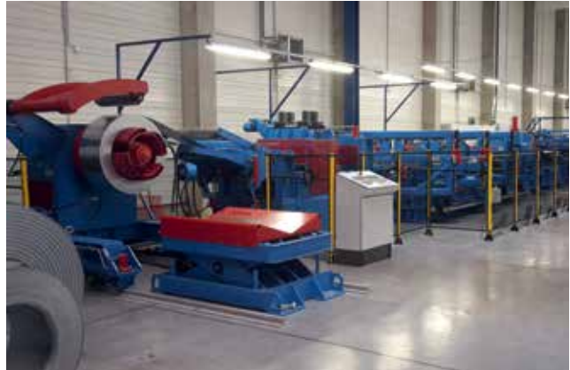
5. kép: Swedsteel Z-/C-profilozó hengerson
