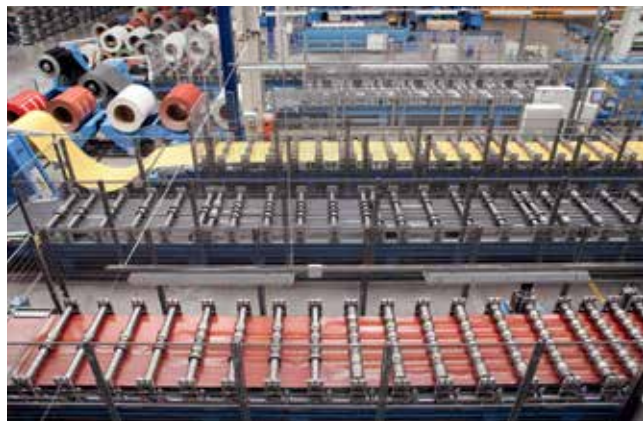
6. kép: Swedsteel cserepes-, trapéz- és szinuszlemezgyártó sor
