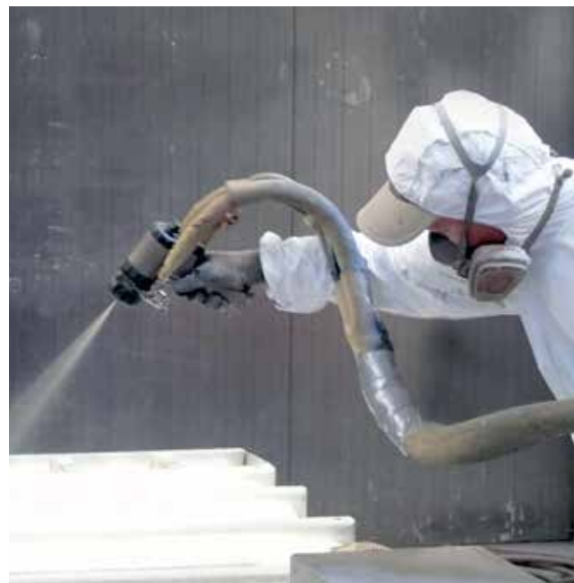
3. kép: Forrón szórt bevonat készítése
